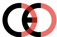
Falsk CE-mærke (for tæt på hinanden)
